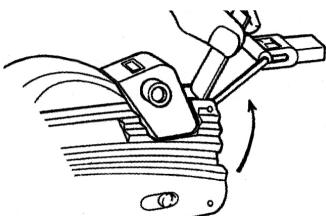
Otvorite prednji poklopac i izvadite istrošeni valjak pomoću priloženog alata. Stavite novi valjak u ležište i blokirajte ga laganim pritiskom. Zatvorite prednji poklopac.
