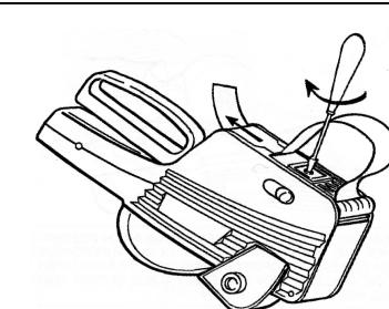
Ako otisak nije centriran na etiketi, možete ga centrirati na slijedeći način: otpustite vijak na donjem poklopcu i pomičući pločicu sa metalnim valjkom naprijed natrag, centrirajte otisak. Pritegnite ponovno vijak.
