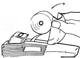
Otvorite gornji poklopac lagano ga povlačeći prema gore. Odmotajte oko 20 cm trake i spustite rolu u etiketirku tako da odmotani dio trake prođe van kroz donji dio etiketirke.
