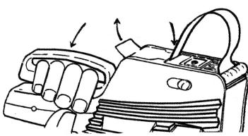
Stavite dio trake bez etiketa u prostor iza metalnog valjka i istovremeno stisnite ručku nekoliko puta dok ne počnu izlaziti ispravno otisnute etikete.
